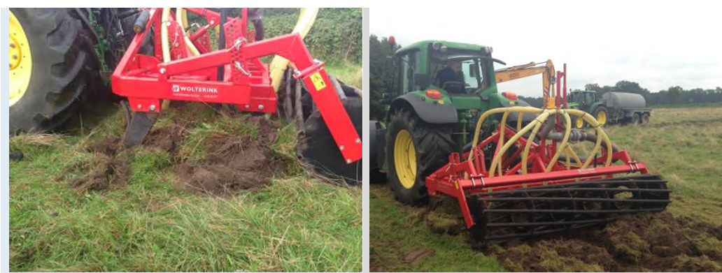
FIGUUR 4-5. GRASZODE TE LANDGOED MENTINK WERD NIET GOED DOORSNEDEN EN HOOPT ZICH OP TUSSEN DE MESSEN.
