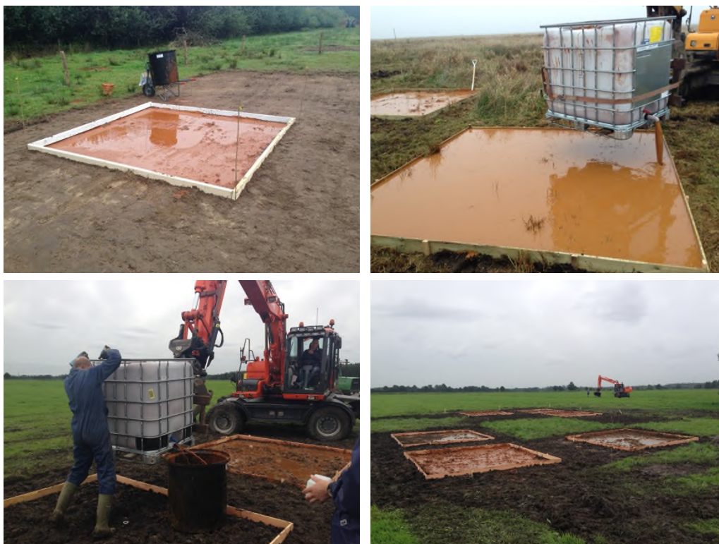
FIGUUR 3-6. TOEDIENING VAN DRINKWATERSLIB. LINKSBOVEN: HANDMATIG TE SCHEEKEN. RECHTSBOVEN EN LINKSONDER: M.B.V. KRAANVOERTUIGEN IN DE ONNERPOLDER EN BLOEMKAMPEN. RECHTSONDER : DRIE PROEFVLAKKEN MET IJZERSLIB EN DRIE MET IJZERKALKSLIB TE BLOEMKAMPEN.
